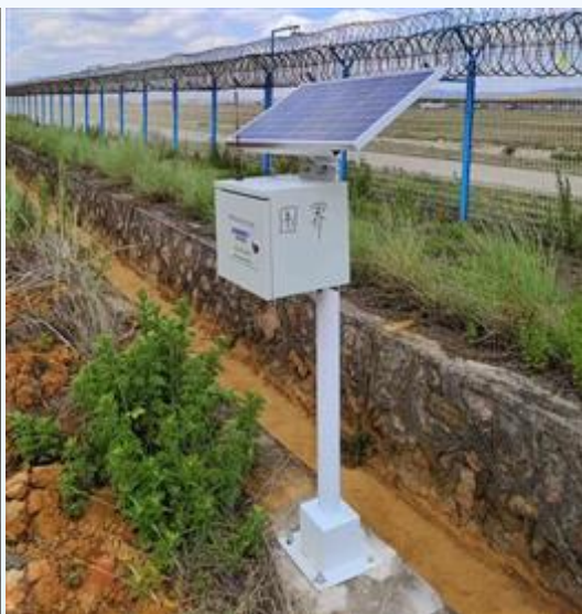
太阳能发电装置供电，支持连续 15个阴雨天供电
