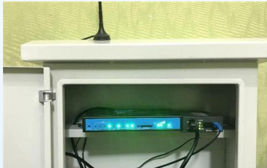
4G路由器与光纤收发器结合，支持多个测点接入 通讯网络
