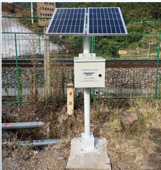
太阳能发电装置供电，支持连续 10个阴雨天供电
