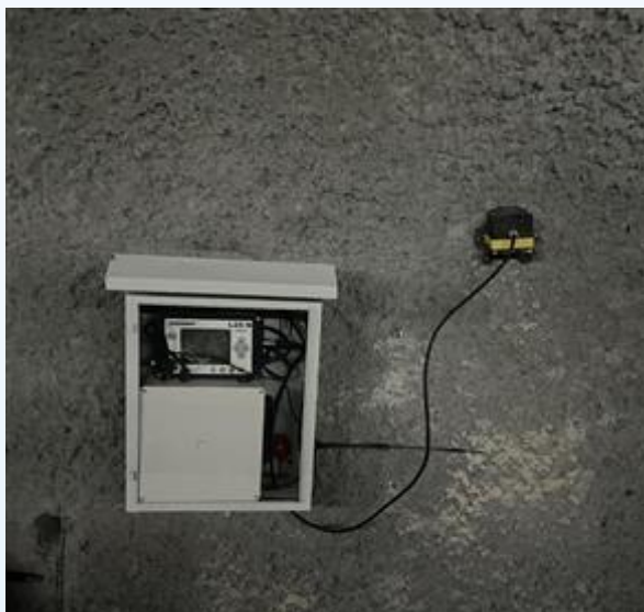
40AH蓄电池，节能模式下支持 30天供电
