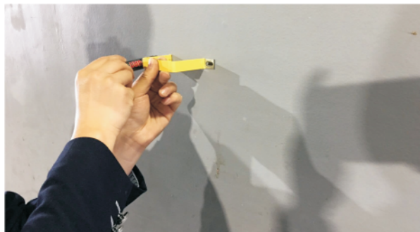
1、选择平整墙面为安装点，能够反映真实振动
