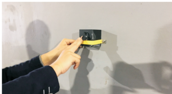
3、用夹具将传感器固定在墙面上
