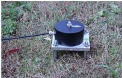
软沙（土层）安装
