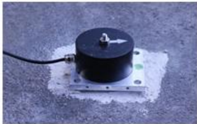
混凝土（岩）面安装
