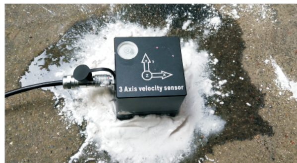
3、X轴指向爆心，水平放置，与被测面紧密粘合
