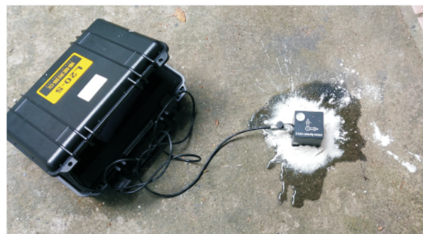
4、监测仪放置防护箱内，避免飞石破损仪器
